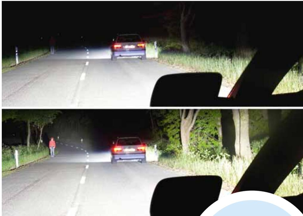
und Abbiegelicht als Serien- oder Zusatzausstattung verfügbar. Beim Kurvenlicht schwenkt der Lichtkegel orientiert am Kurvenradius und der Geschwindigkeit in die gewünschte Richtung und leuchtet die Kurve optimal aus. Der Fahrbahnverlauf, mögliche Hindernisse und schlecht oder gar nicht beleuchtete Verkehrsteilnehmer sind so frühzeitig erkennbar. Das Abbiegelicht hingegen schaltet sich automatisch nur bei Abbiegesituationen zu. So können zum Beispiel Fußgänger besser erkannt werden.
