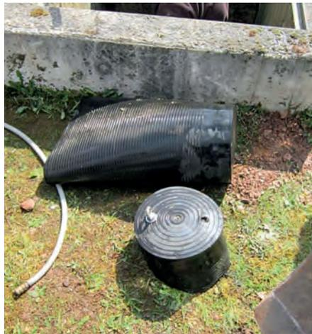
Abb. 4: Geplatze Absperrblase, ein Mitarbeiter hielt sich im Schacht direkt hinter der Absperrblase auf und wurde erheblich verletzt (Foto: BG BAU)
