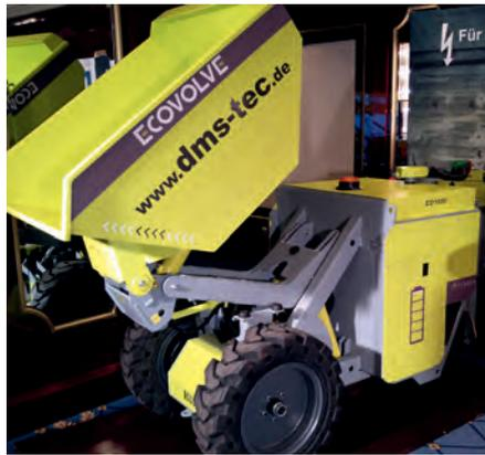
Abb. 2: Einen vollständig elektrisch betriebenen Dumper präsentierte die Fa. DMS. Der eingesetzte Induktionsmotor hat eine Leistung von 5 bzw. 8 kW. Die Maschine kann im Innen-, jedoch auch witterungsunabhängig im Außenbereich eingesetzt werden.
