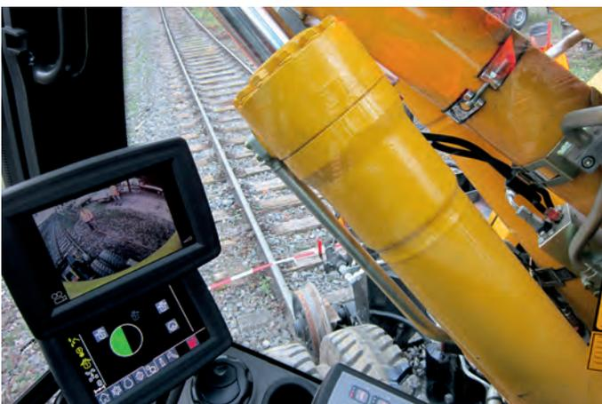
Abb. 3: Seitenraumkamera und Scheinwerfer am Zweibege-Bagger, montiert auf der rechten Oberwagenseite
