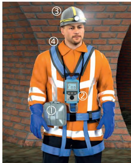
Abb. 2: Notwendige Hilfsmittel bei Tätigkeiten in abwassertechnischen Anlagen ① Selbstretter, ② Messgerät, ③ Helm mit Kopfleuchte, ④ Rettungsgurt (Grafik: BG BAU/H2S)
