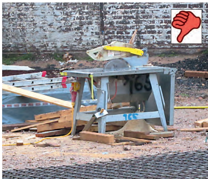
Abb. 6: Manipulation der Sicherheitseinrichtung – Feststellen einer am Spaltkeil befestigten selbsttätig schließenden Schutzhaube (Foto: Opara)
