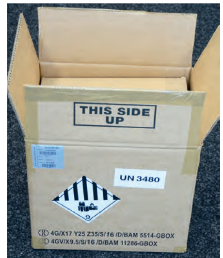
Abb. 9: Bauartzugelassene Gefahrgutverpackung für Akkus mit Gefahrgutlabel 9A und UN-Nummer 3480 (Lithium-Ionen-Batterien) (Foto: H.-J. Kuhnsch, BG BAU)
