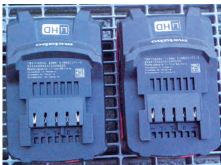
Abb. 7: Zwei äußerlich gleiche Akkus mit unterschiedlichem Energieinhalt: 99 Wh und 112 Wh (Foto: H.-J. Kuhnsch, BG BAU)
