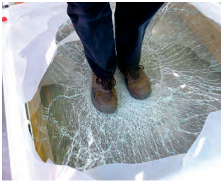
Abb. 8: Durchsturz-sicheres Glas unterhalb einer Lichtkuppel (Foto: BG BAU/Otto)
