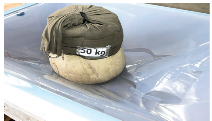
Abb. 12 und 13: Prüfung einer Lichtkuppel mit Fallstopp-Beschichtung (Foto: Kemper System GmbH)
