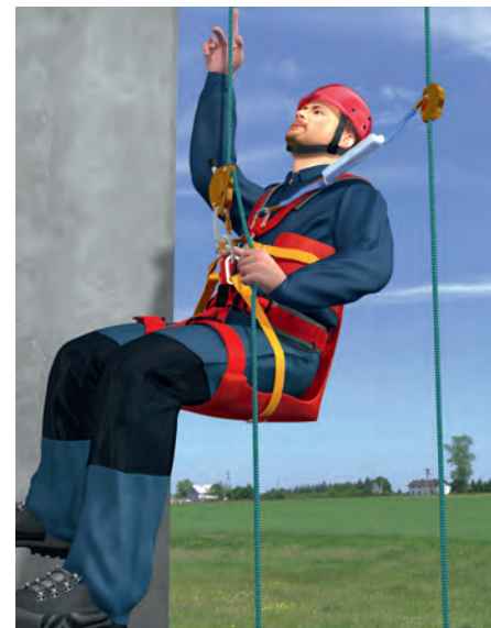
Abb. 3: Kopfschutz bei SZP (Seilzugangs- und Positionierungsverfahren)
