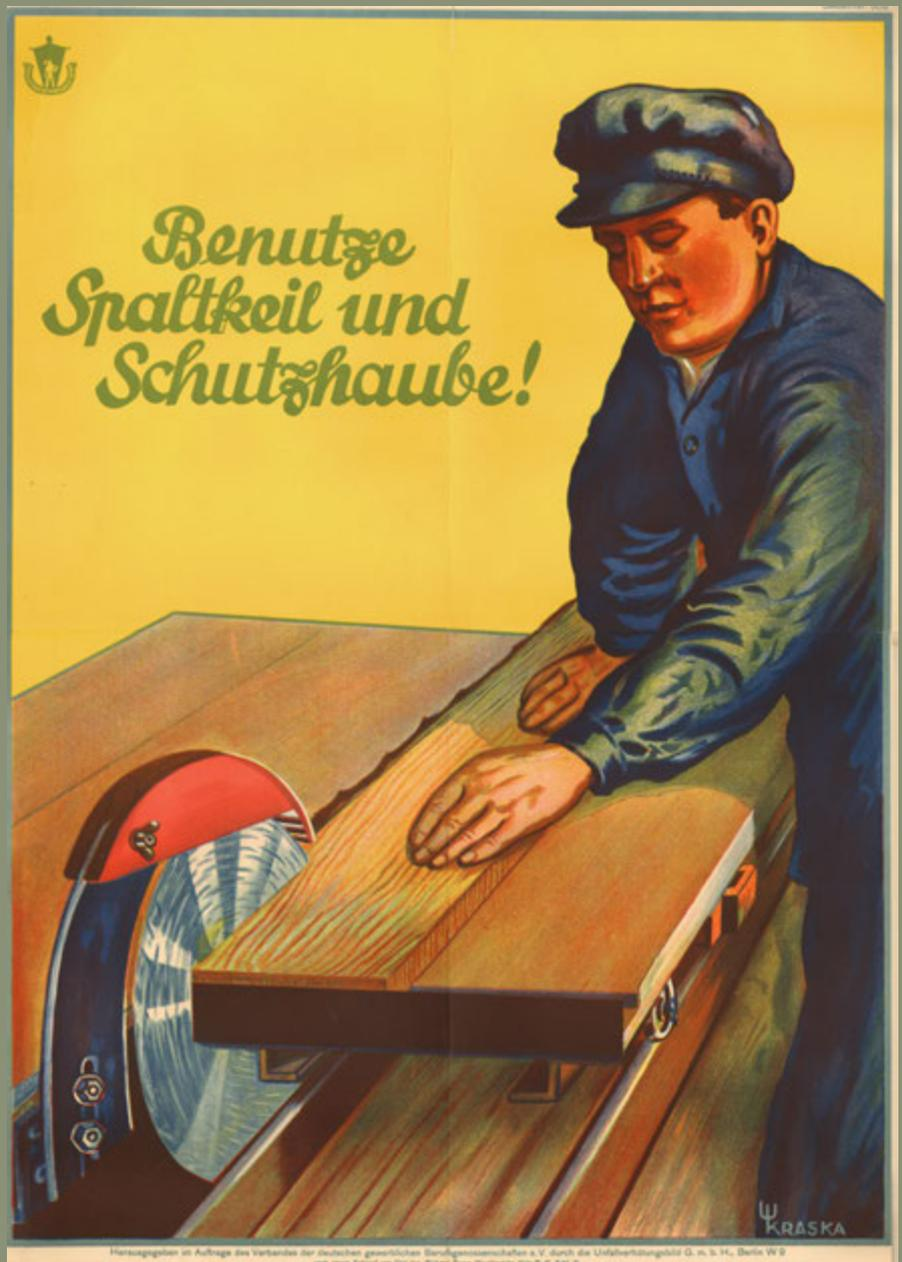
Finger weg von der Schnittlinie und Daumen an den Zeigefinger – das sind die wichtigsten Regeln beim Arbeiten mit der Kreissäge. Gehör- und Augenschutz sind unverzichtbar. Ein korrekt eingestellter Spaltkeil verhindert gefährliche Rückschläge. Und die Schutzhaube? Die wird nicht manipuliert, das versteht sich von selbst.
