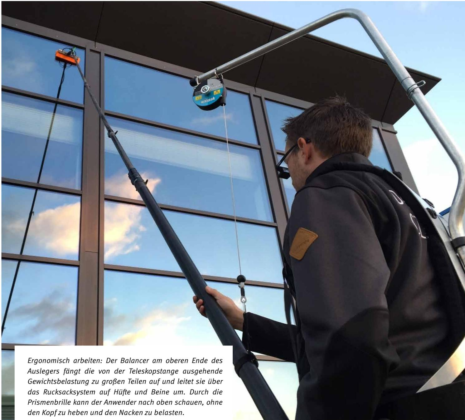
*Ergonomisch arbeiten: Der Balancer am oberen Ende des Auslegers fängt die von der Teleskopstange ausgehende Gewichtsbelastung zu großen Teilen auf und leitet sie über das Rucksacksystem auf Hüfte und Beine um. Durch die Prismenbrille kann der Anwender nach oben schauen, ohne den Kopf zu heben und den Nacken zu belasten.*
