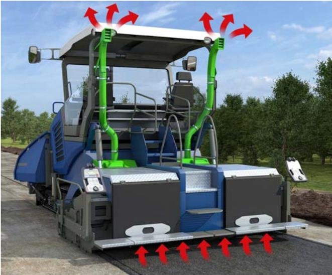
weniger Bitumendämpfen und Aerosolen ausgesetzt. Unternehmen sollten bei der Beschaffung von neuen Fertiggern darauf bestehen, dass sie mit einer Absauganlage ausgerüstet sind.
