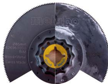
Vergleich von Schneidmesser neu und nach dem Einsatz bei den Versuchen
