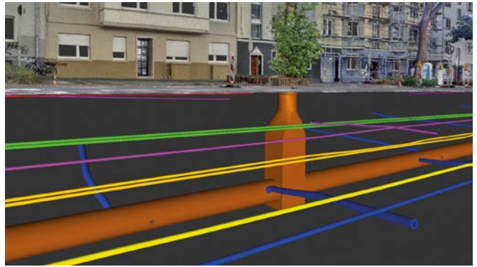
Zusammengeführtes 3D-Modell des Untergrunds: per Georadar geotetete Leitungen und per Laserscan erfasste Bauwerke, liegen genau zu einem konsistenten Datensatz vereinigt
