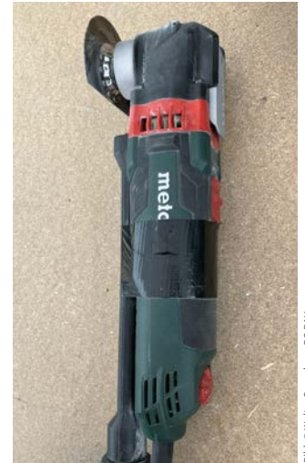
Multitool mit improvisierter Absaugung
