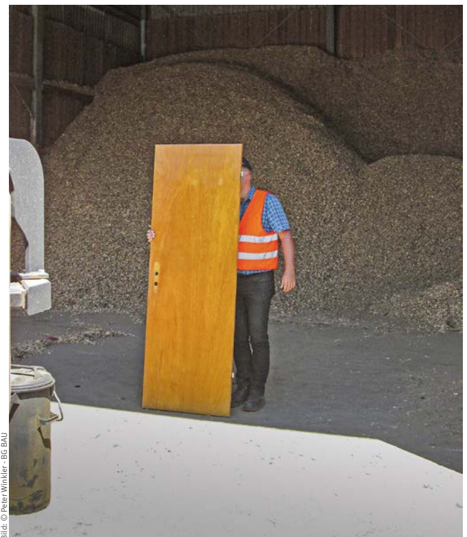
Prüfung nach dem GS BAU 71, ab wann ein System eine Person erkennt
