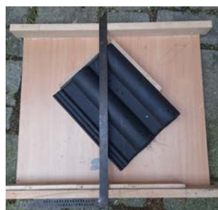
Schablone zum Anzeichnen der Schnittlinien
