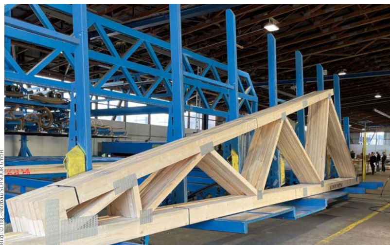
Fertigung von Nagelplattenbindern
