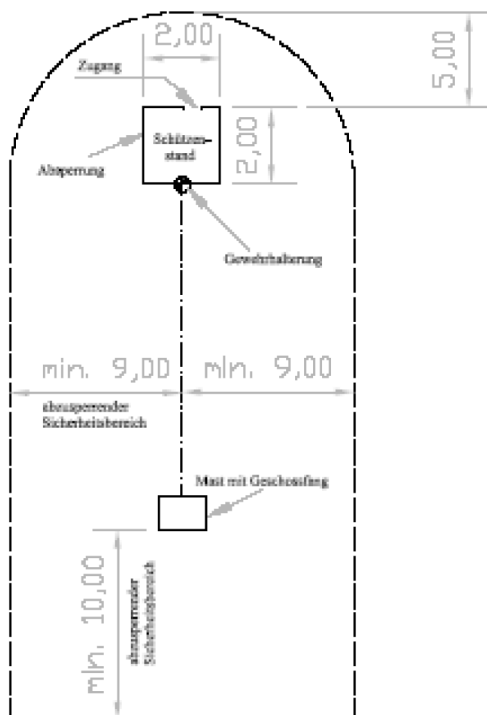
Abbildung 7.9.1 Sicherheitsbereich für Vogelschießstände
