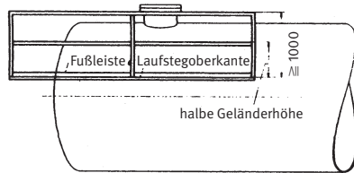
Arbeitsbühne mit freistehendem Geländer, z. B. bei Chemikalienfahrzeugen
