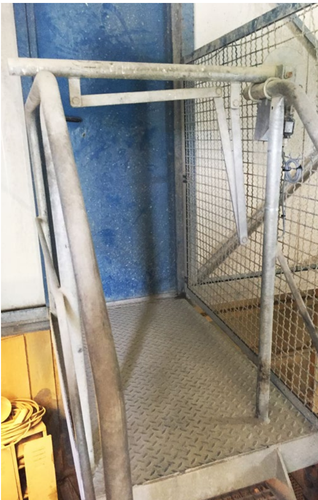
Abb. 34 NEGATIV: Leicht umgehbare Absicherung zum Schrapper
