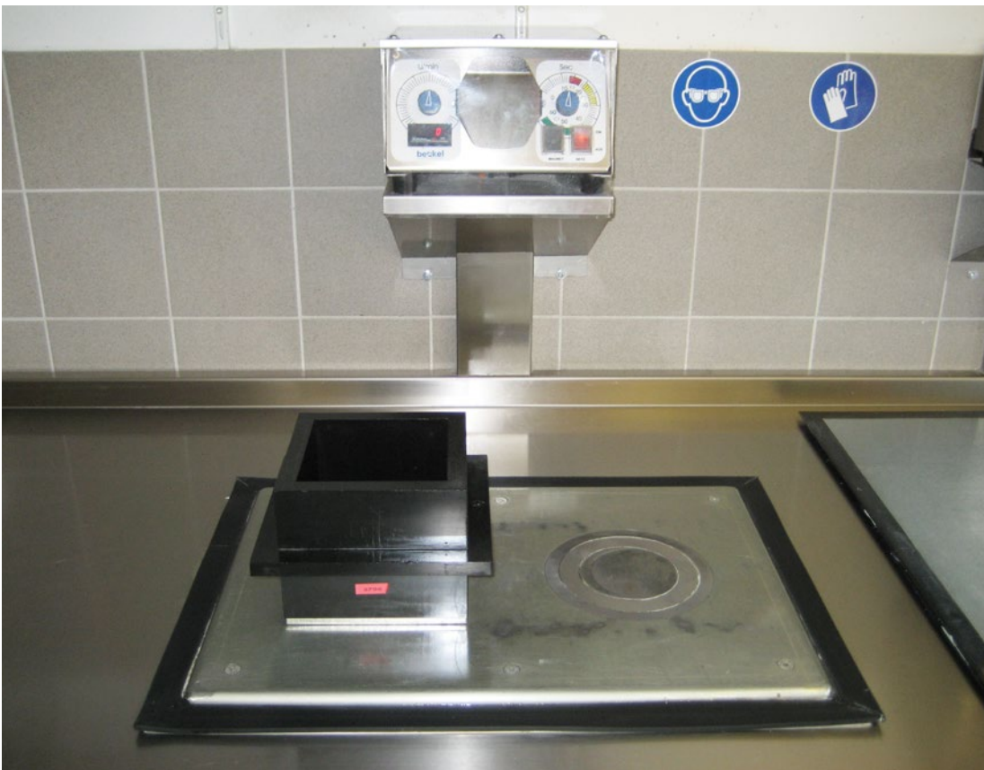
Abb. 56 magnetischer Rütteltisch – reduziert Lärmbelastung
