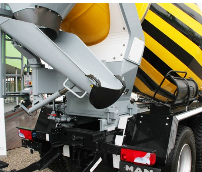
Abb. 45 Gewinner des BG RCI Förderpreis „Sicherheit auf allen Wegen“ 2015 – Auslaufschutz für Betonrutschen
