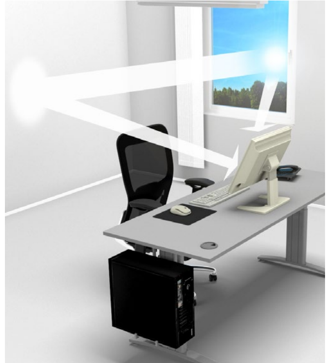
Abb. 17 Auf blendfreie Positionierung des Bildschirms achten
