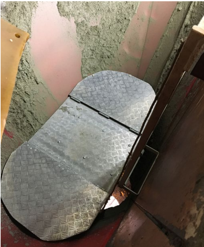
Abb. 21 Arbeitsbühne im Austragstrichter
