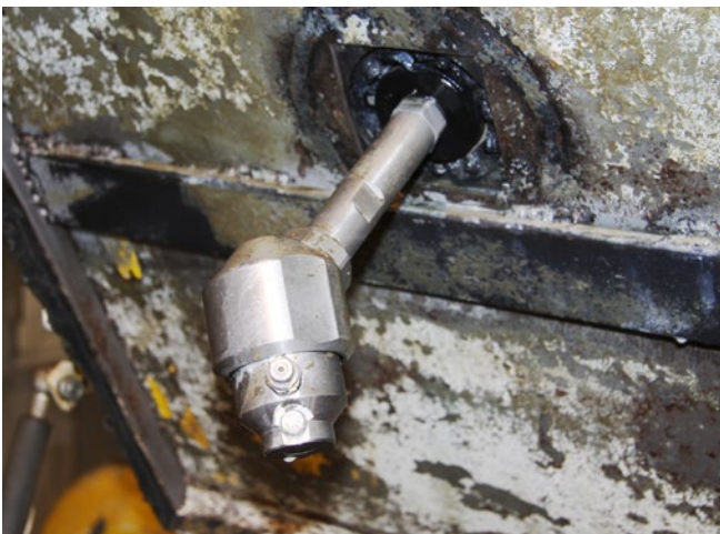
Abb. 24 Hochdruckreinigungsdüse in Betonmischer
