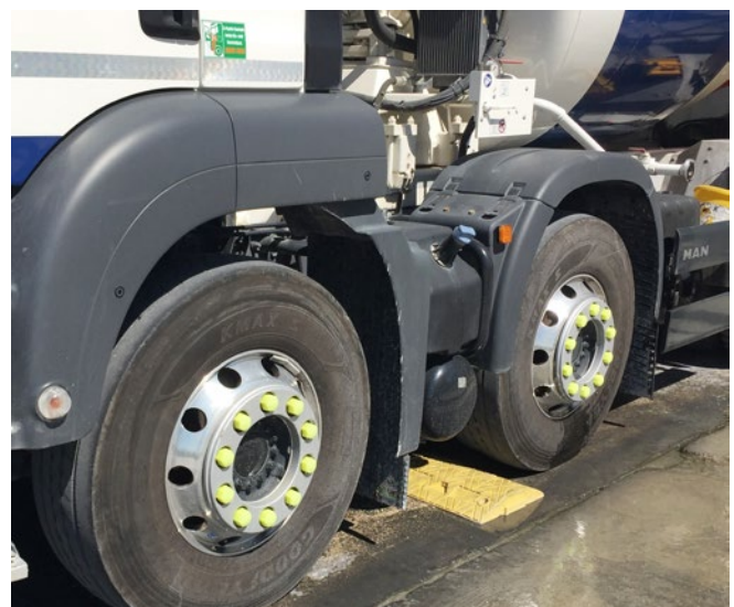
Abb. 46 Bodenschwelle um ungewolltes Bewegen des Fahrmischers zu vermeiden
