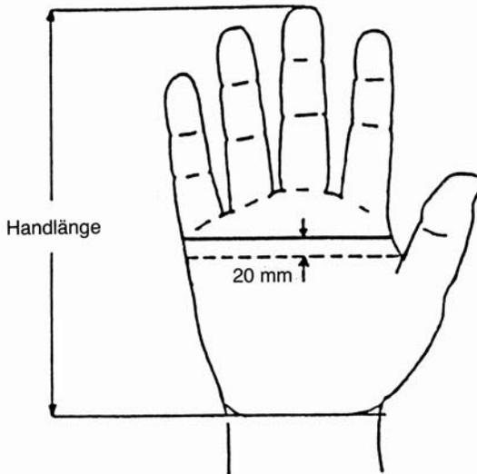
**Abb. 2:** Bestimmung der Maße für Umfang und Länge
