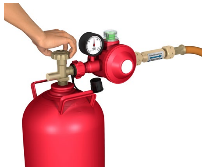
Abb. 10 Einflaschenanlage mit direkt angeschraubter Druckregleinrichtung ( keine Zone nach Kontrolle der Dichtheit)
