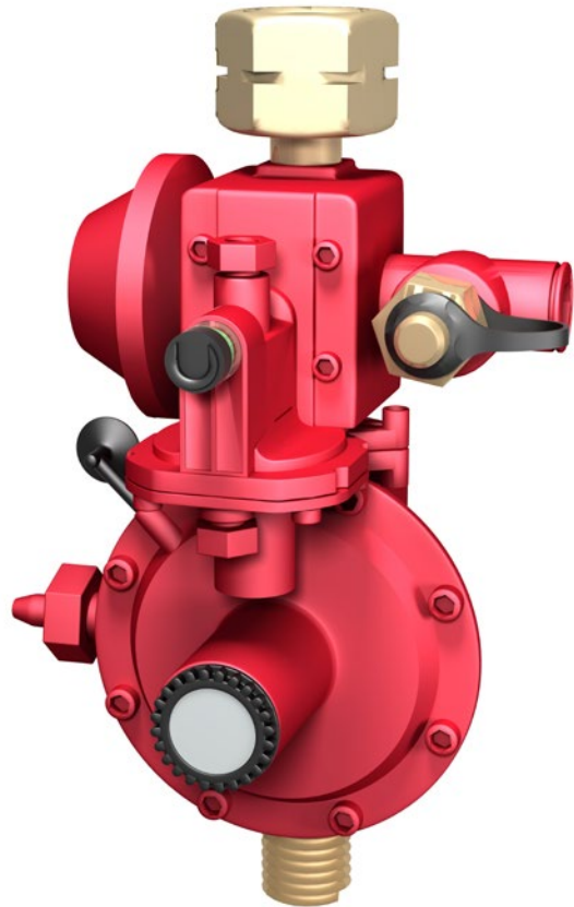
Abb. 25 OPSO/UPSO Druckregleinrichtung mit Überdruck-Abblaseventil mit begrenztem Durchfluss (Pressure Relief Valve (PRV)) und einer Versorgungsleistung von z. B. 12 kg/h
