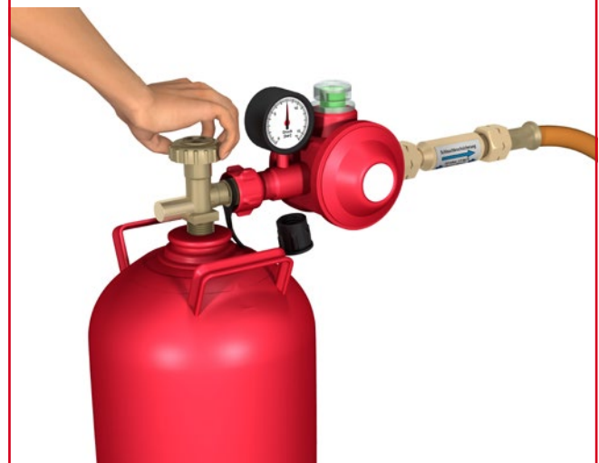
Abb. 30 Zudrehen des Flaschenventils (Flaschenventil = Hauptabsperreinrichtung, Drehrichtung rechts)
