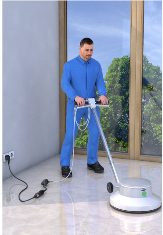
Abb. 70 Einscheibenmaschine mit PRCD-S
