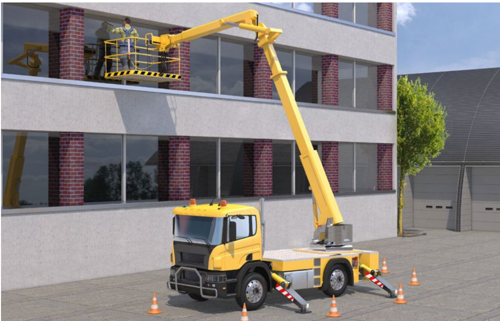
Abb. 41 Teleskopbühne im Einsatz
