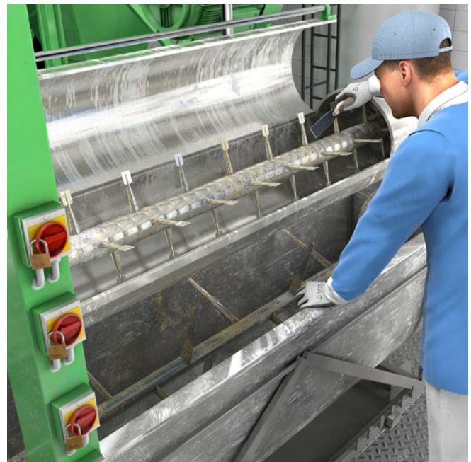
Abb. 73 Anlage gegen Einschalten gesichert
