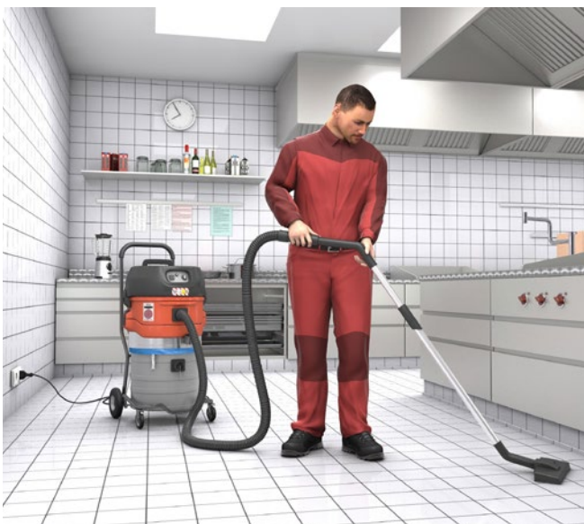
Abb. 12 Anschluss eines Betriebsmittels nur an geprüfter Steckdose
