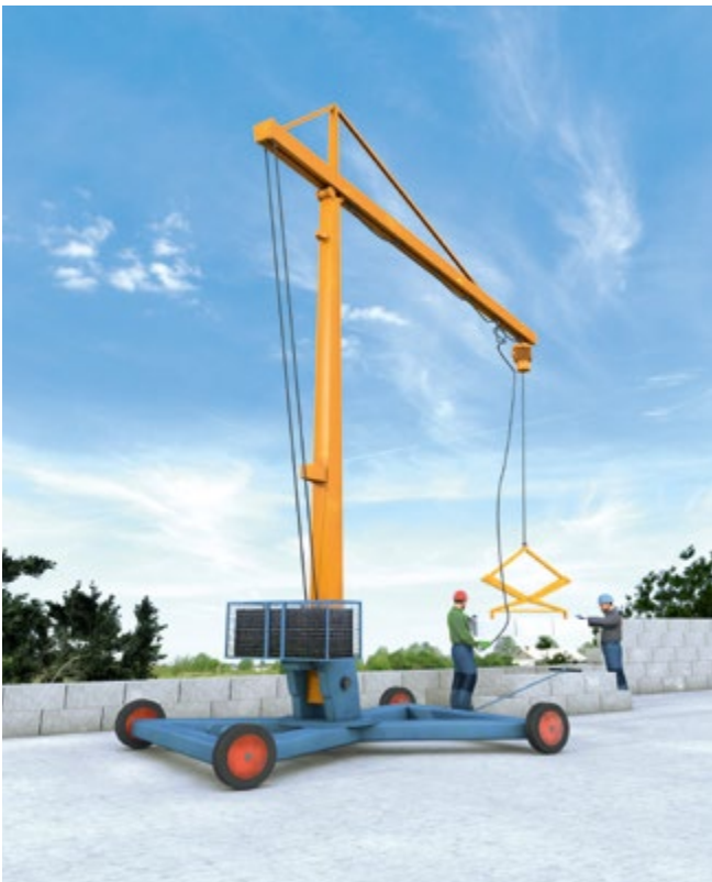
Abb. 74 Steinversetzkran zum Mauern großformatiger Steine
