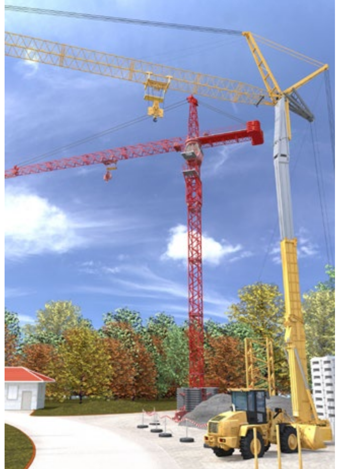
Abb. 71 Stationärer und mobiler Kran
