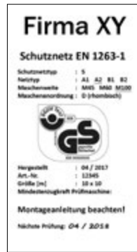
Abb. 60 Beispiel einer Kennzeichnung des Schutznetzes nach EN 1263-1
