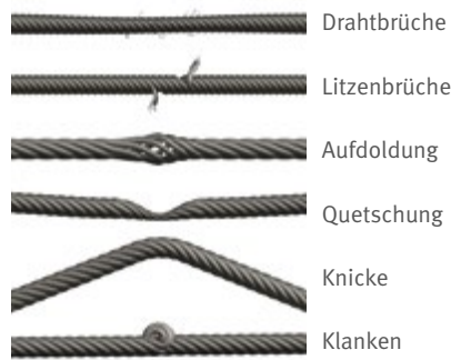
Abb. 91 Beispiele für Ablegekriterien von Drahtseilen
