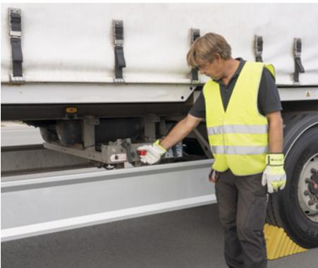
Abb. 32 Seitliche Bremsbetätigungseinrichtungen
