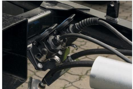
Abb. 20 Verbindungsleitungen in Parkdose stecken
