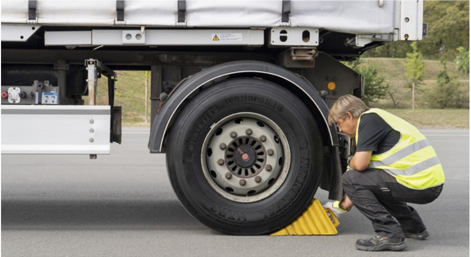
Abb. 18 Anlegen der Unterlegkeile
