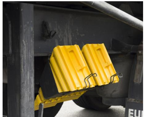
Abb. 33 Möglichst zwei Unterlegkeile je Anhänger
