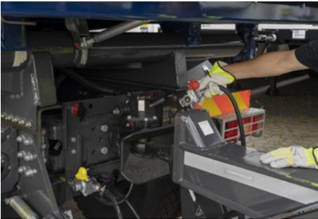
Abb. 19 Verbindungsleitungen trennen
