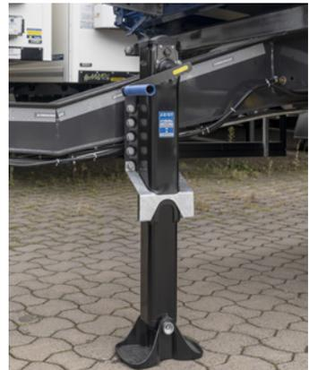
Abb. 7 Stützeinrichtung eines Starr-Deichselanhängers
