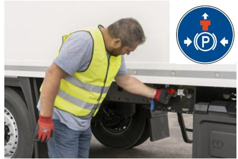
Abb. 28 Betätigen der Feststellbremsen
