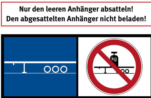
Abb. 26 Kennzeichnung an Sattelstützen geringerer Tragfähigkeit
