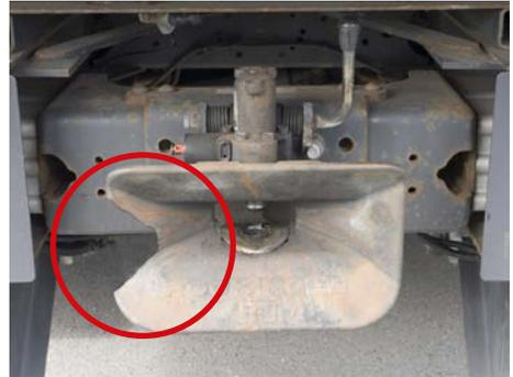
Abb. 37 Fangmaul auf Arretierung und Schäden kontrollieren
