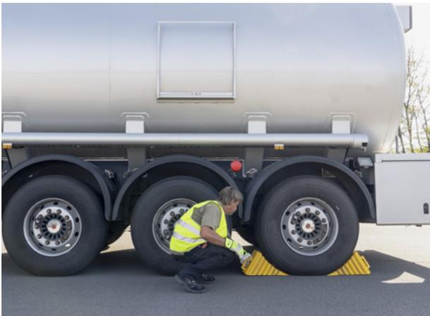
Abb. 29 Anlegen der Unterlegkeile
