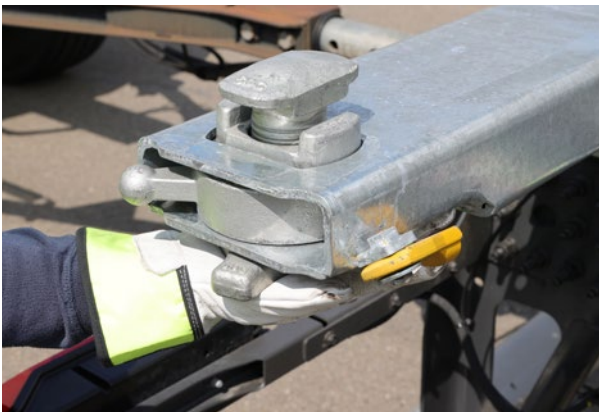
Abb. 26 Spannmutter anheben und Drehzapfen drehen
