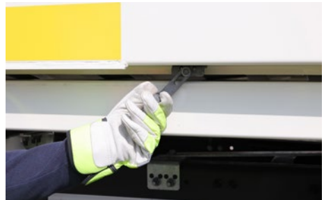
Abb. 7 Lösen der Transportsicherung (Fallsicherung)
