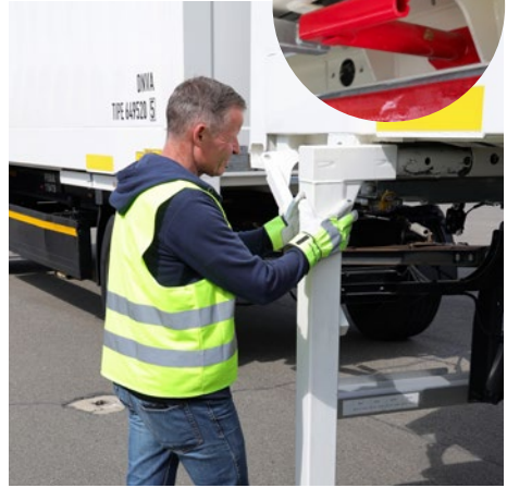
Abb. 13 Stützbeinverriegelung einrasten lassen und Verriegelung kontrollieren
