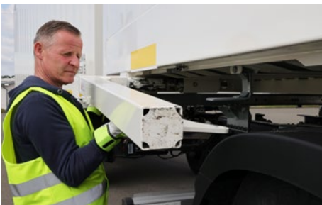
Abb. 8 Stützbein mit Stützbeinstrebe mit beiden Händen herausziehen
