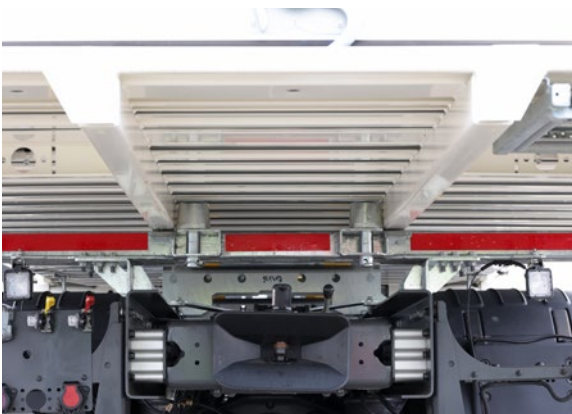
Abb. 25 Führungsrollen laufen bestimmungsgemäß im Führungstunnel
