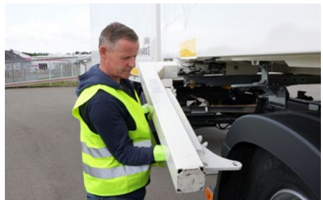
Abb. 9 Stützbein mit Stützbeinstrebe herabschwenken
