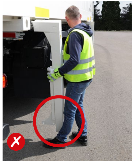
Abb. 11 Achtung: Verletzungsgefahr im Schwenkbereich!
