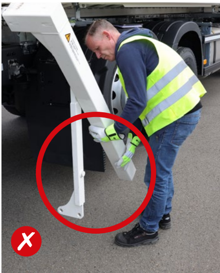
Abb. 10 Achtung Quetschgefahr: Stützbein und Stützbeinstrebe niemals fallen bzw. pendeln lassen!
