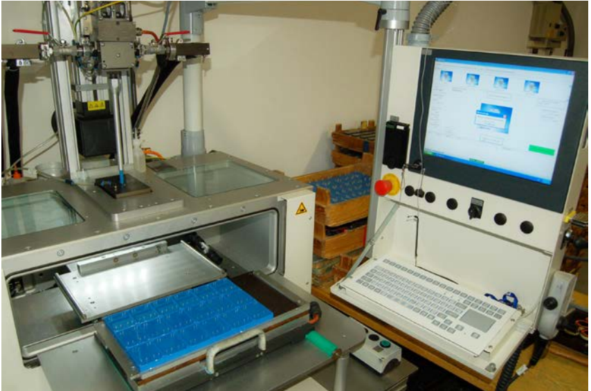
Abb. 20 Baugruppen nach dem Verguss mit Epoxidharzen
