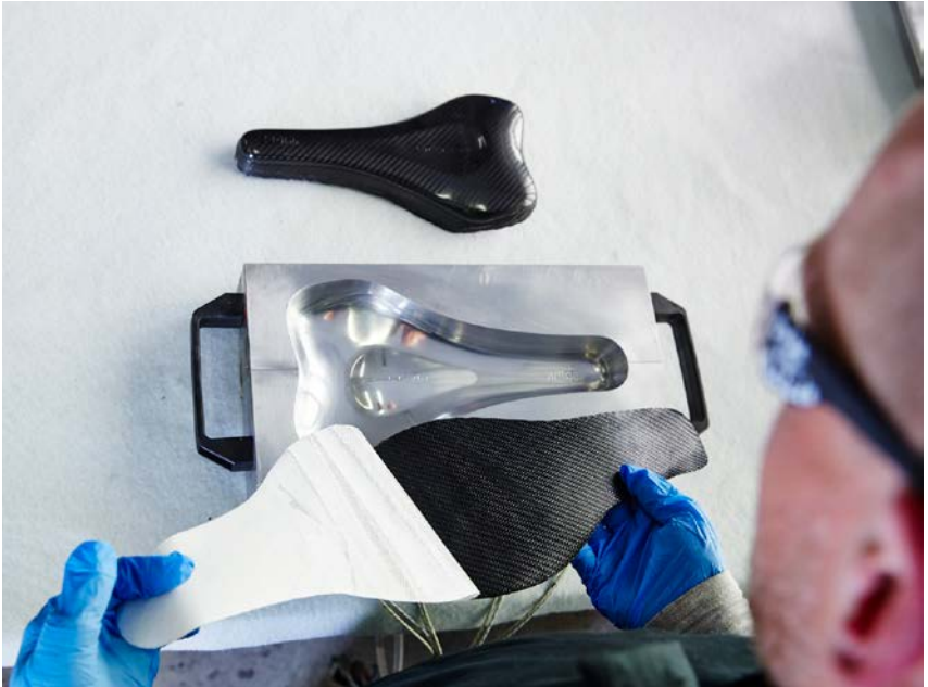
Abb. 29 Das mit Epoxidharz vorimprägnierte und zurechtgeschnittene Prepreg wird in einer Form unter Wärme und Druck ausgehärtet.
