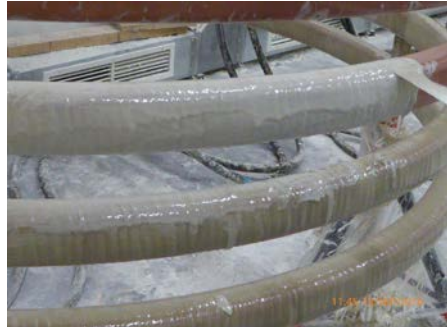
Abb. 34 a, b Umwickeln der Spulen mit epoxidharzgetränktem Gewebeband
