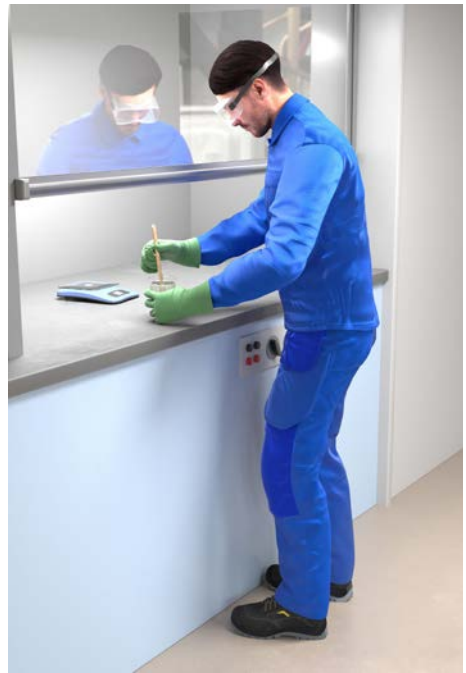
Abb. 16 Mischen von Epoxidharzsystemen
