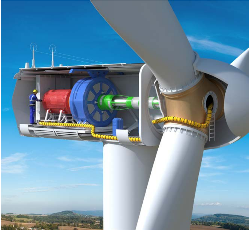
Abb. 4 Absaugschlauch vom Axialventilator zum Rotorblatt zur Absaugung der Luft
