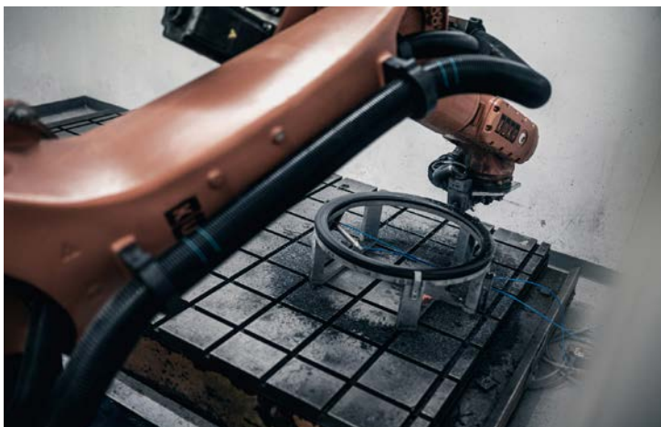
Abb. 41 robotergestützte Schleif- und Fräsarbeiten
