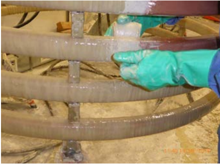
Abb. 34 a, b Umwickeln der Spulen mit epoxidharzgetränktem Gewebeband
