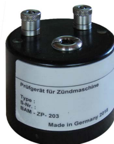
Abb. 6b Beispiel eines Zündmaschinen- prüfgeräts herkömmlicher Bauart
