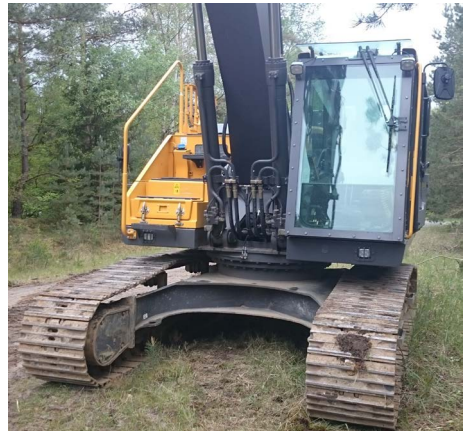
Abb. 34 Bagger mit Sicherheitssonderverglasung
