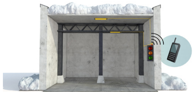
Abb. 8 Messung mittels Dehnmessstreifen
