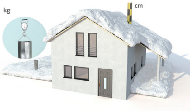
Abb. 7 Messung mittels Messrohr und Pegel
