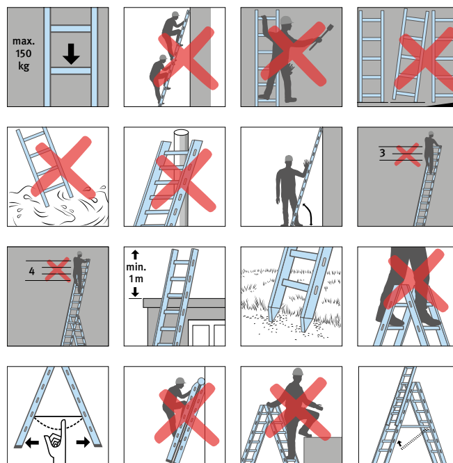
Abb. 14: Verhaltensmaßnahmen für die Benutzung tragbarer Leitern
