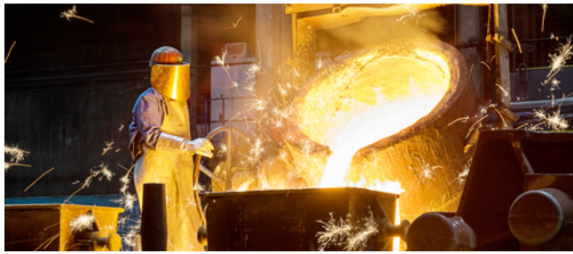
Abb. 15 Verwendung von PSA gegen Hitze beim Gießen
