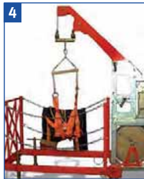
Einfahren mit Siloeinfahrvorrichtung.
