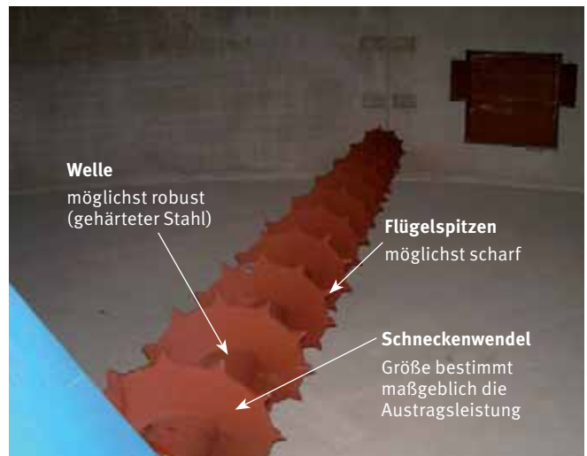
Abb. 6.10 Konstruktionsmerkmale einer Austragschnecke
