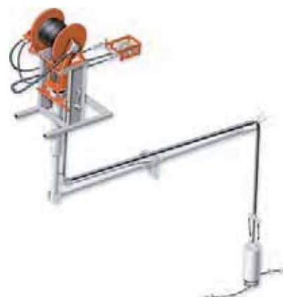
Abb. 8.4 Gelenkarm mit pneumatisch betriebenen Rotationsmotor
