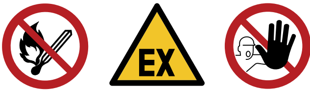
Abb. 5.6 Verbotsschilder an Silozugängen
