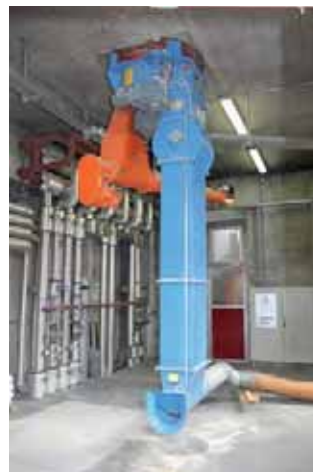
Abb. 7.10 Späneentnahme über Anschluss an gesonderten Entnahmestutzen
