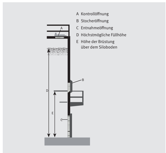
Abb. 5.4 Korrekte Anordnung der Entnahme- und Stocheröffnungen
