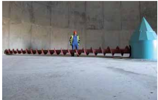
Abb. 6.9 Horizontale Austragsschnecke im Bodenbereich
