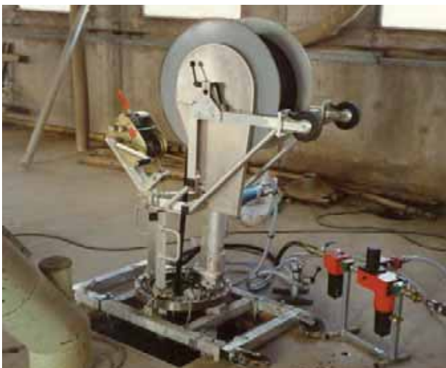
Abb. 8.5 Bedieneinrichtung, Energiezufuhr und Steuerung außerhalb des Späne-Lagerraumes
