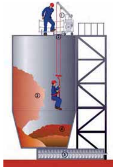
Abb. 7.14 Prinzip-Skizze zum Befahren eines Silos
