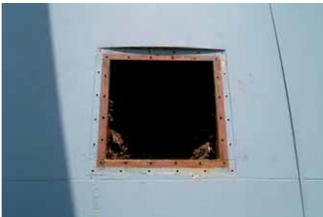
Abb. 8.9 Vorgefertigte Öffnung für den Einsatz eines Notentleerungssystems
