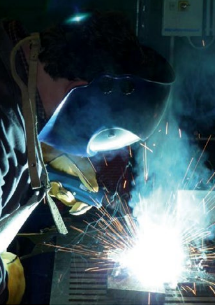
Abb. 1 Aufsteigender Schweißrauch ohne Absaugung
