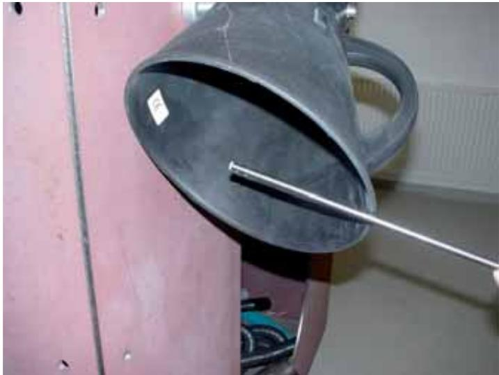
**Abbildung 12:** Messung der Wirksamkeit einer lufttechnischen Anlage mit einem Thermoanemometer
