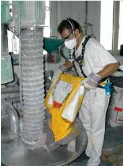
**Abbildung 49:** Manuelle Sackaufgabe mit verbesserter Erfassungseinrichtung und geschützter Rührwelle
