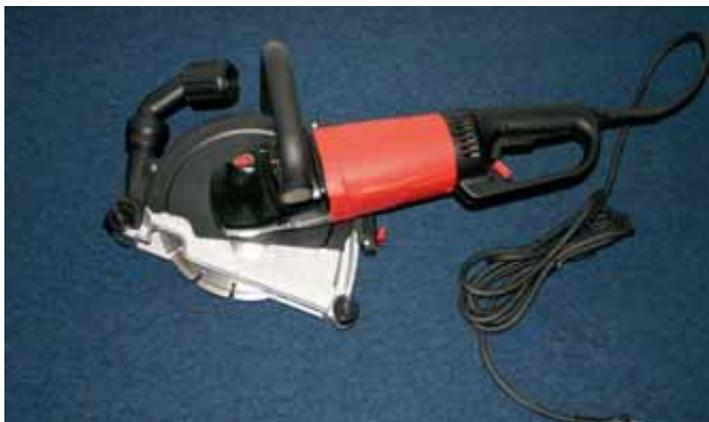
**Abbildung 32:** Diamant-Winkeltrennschleifer mit weitestgehend geschlossenem Stauberfassungselement
