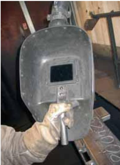
**Abbildungen 16 und 17:** Schutzschild mit integrierter Absaugung
