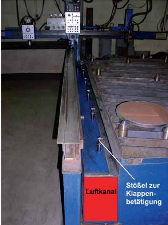
**Abbildung 20:** Luftkanal mit Klappensteuerung
