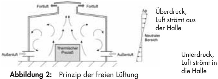
**Abbildung 2:** Prinzip der freien Lüftung
