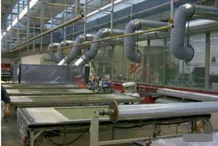
**Abbildung 38:** Verarbeitung der GFK- und GFP-Materialien mit Absaugung und raumlufttechnischer Anlage (RLT-Anlage)
