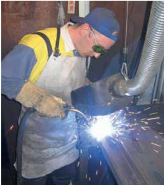
**Abbildung 18:** Wirkungsvolle Erfassung beim Schweißen mit einem Schutzschild mit integrierter Absaugung
