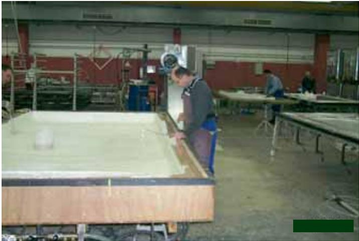
**Abbildung 37:** Verarbeitung der GFK- und GFP-Materialien ohne Absaugung mit raumluftechnischer Anlage (RLT-Anlage)
