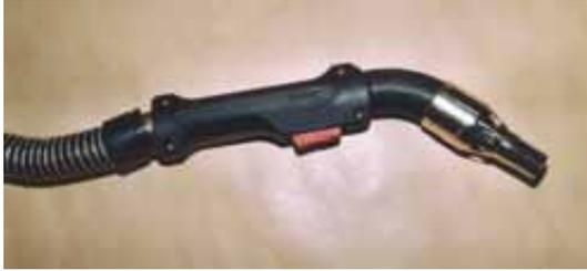
**Abbildung 14:** Brennerintegrierte Absaugung
