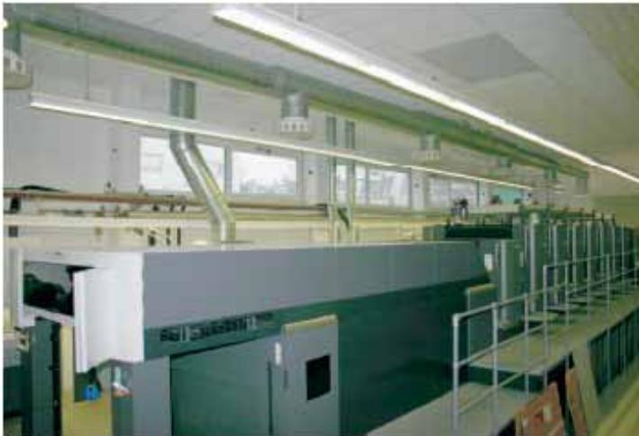
**Abbildung 45:** Bogenoffsetmaschine im Drucksaal: Alle abgesaugten Emissionsbestandteile werden mittels Abluftleitungen über Dach abgeführt, wodurch ein Eintrag in den Arbeitsbereich ausgeschlossen wird.
