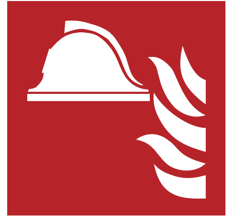
Abb. 14 Kennzeichnung Mittel und Geräte zur Brandbekämpfung
