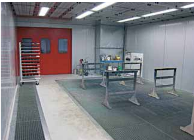
Abb. 1 Lackiererraum mit eigenem Ablüftungsbereich
