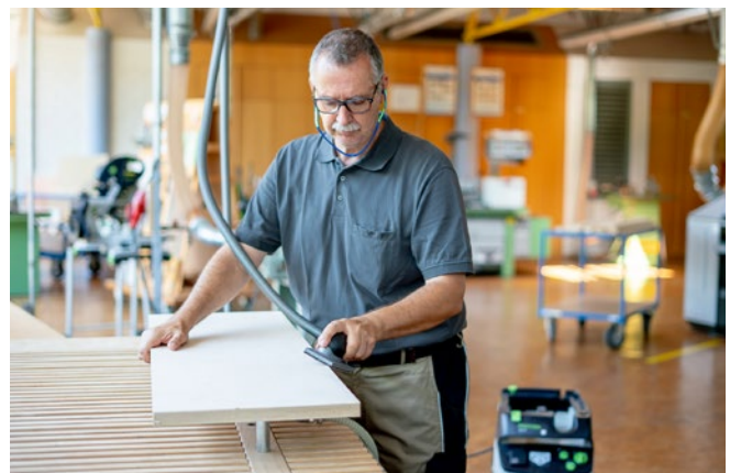
Abb. 12.6 Tischler bearbeitet Werkstück mit einem abgesaugten Handschleifklotz
