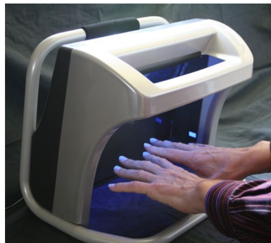
Abb. 4-15 Testgerät (UV-Lampe) zur Überprüfung des Hautschutzes
