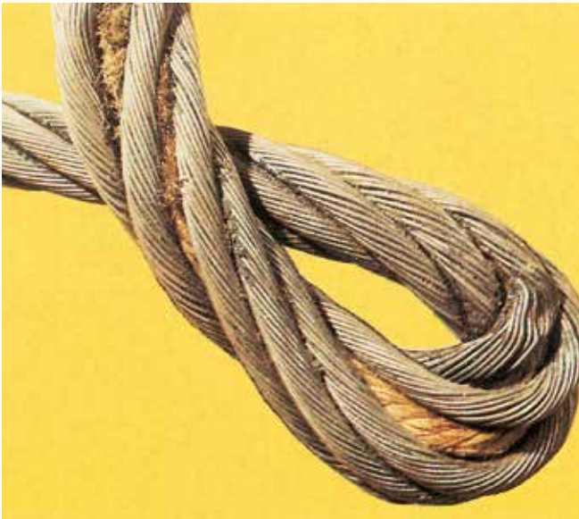
Bild 23-4: Kinke/Klanken und Eindrückung einer Litze. Der Seilverbund ist zerstört: Ablegen!
