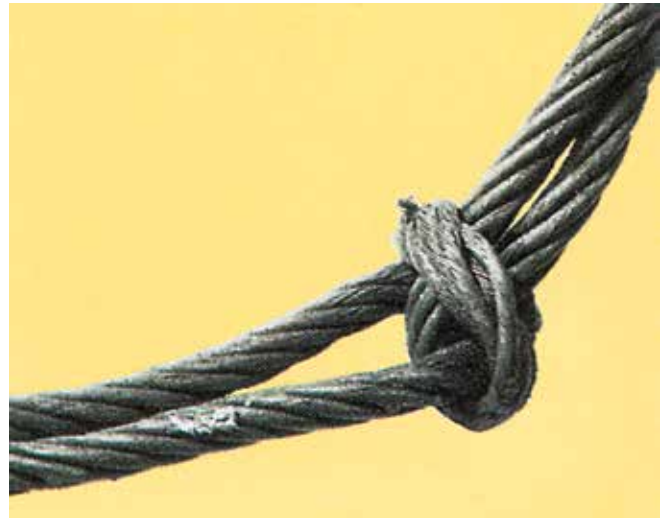
Bild 9-2: Unzulässiger Knoten zerstört den Seilverbund
