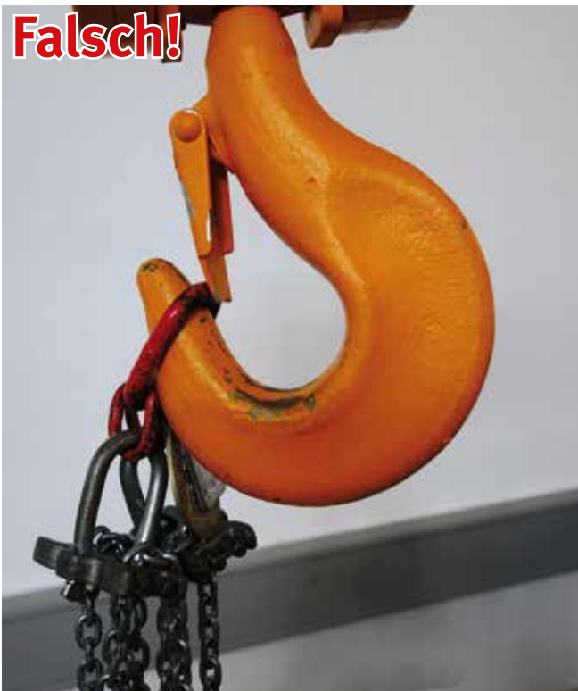
Bild 22-1: Das Aufhängeglied ist für den Kranhaken zu klein. Es wird aufgeweitet und verbogen.
