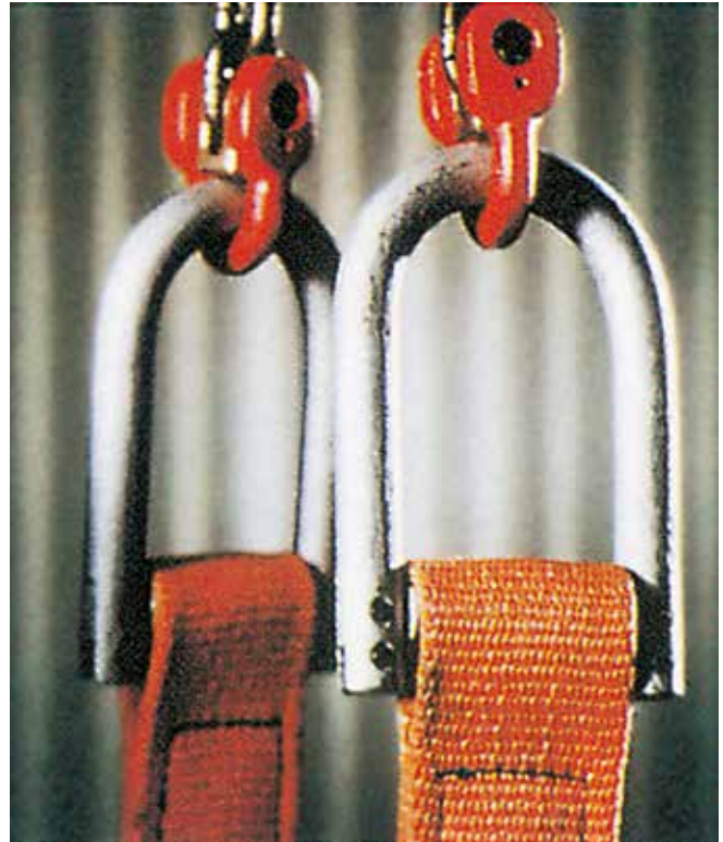
Bild 12-1: Kombination Kette – Hebeband
