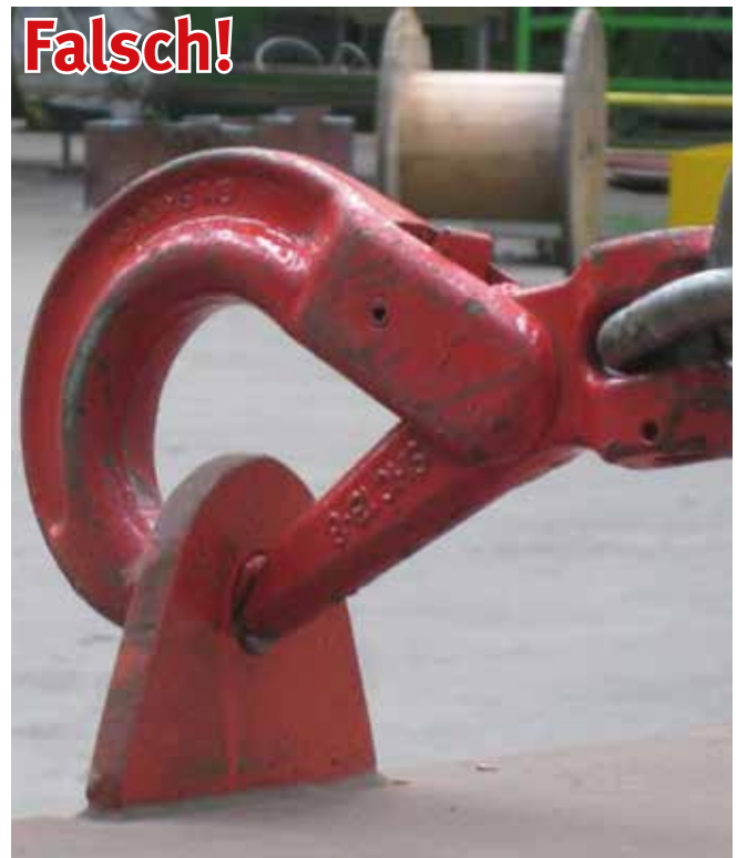
Bild 22-2: Haken ist in eine zu kleine Öse eingehängt. Haken und Öse werden verbogen. Außerdem besteht die Gefahr des unbeabsichtigten Aushängens.
