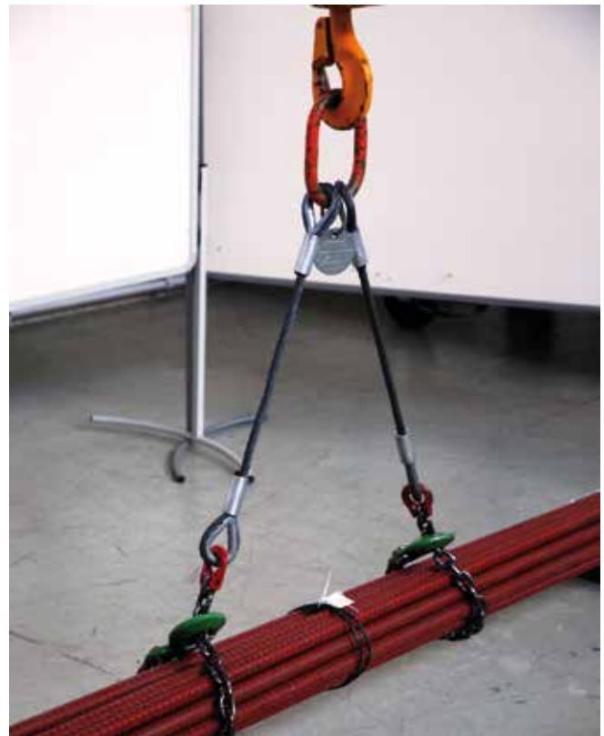
Bild 6-1: Kombination Seil/Kette zur Schonung der Drahtseile
