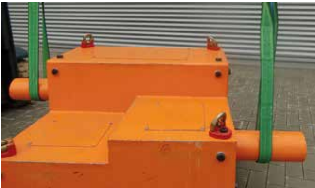
Bild 6-2: Hebebänder sind oberflächenschonend
