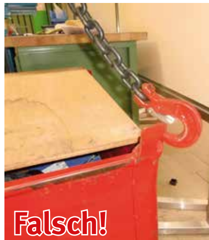
Bild 16-4: Haken rutschen bei Schlaffketten aus den Ösen
