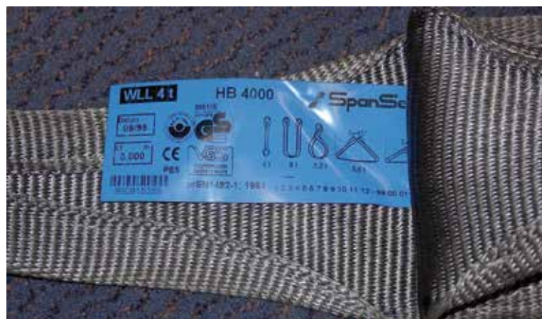
Bild 10-1: Polyester-Hebeband mit eingewebtem Etikett
