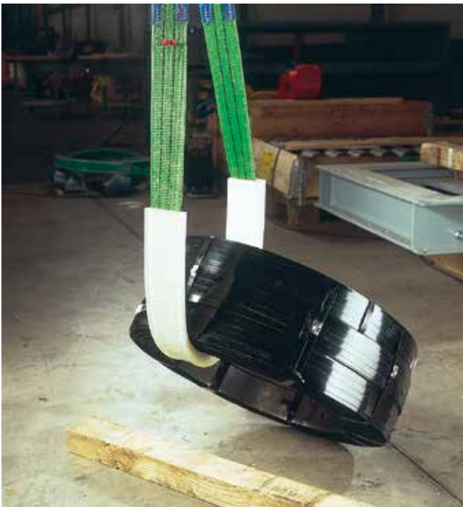
Bild 10-2: Nur der verschiebbare, innen armierte Polyurethan-Schutzschlauch mit starker, mindestens 5 mm dicker Beschichtung ermöglicht das gefahrlose Wenden des Coils, wenn das Band deutlich länger ist als der Kantschutzschlauch
