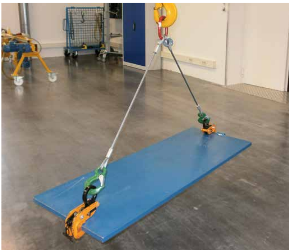
Bild 13-1: Blech horizontal sicher transportiert
