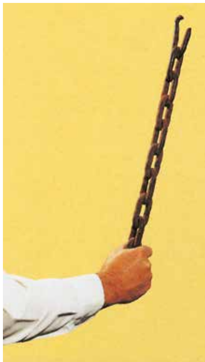
Bild 23-11: Durch Überlastung steif gezogene Kette
