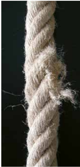
Bild 23-7: Zerstörung einer Litze
