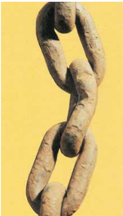
Bild 23-10: Kette mit verbogenem und eingekerbtem Kettenglied
