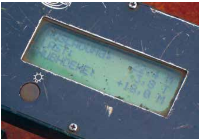
Bild 5-3: Steuerbirne mit digitaler Lastanzeige
