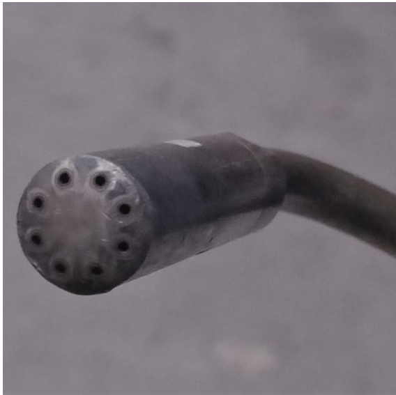
Abb. 8 Geräuscharmer Wärmebrenner mit Mehrlochdüse
