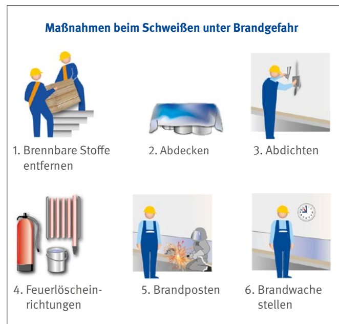
Abb. 15 Maßnahmen beim Schweißen unter Brandgefahr
