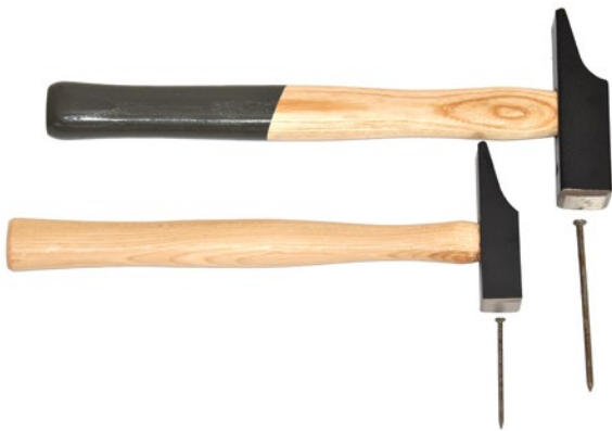
Abb. 16 Hammerkopf passend zur Nagelgröße
