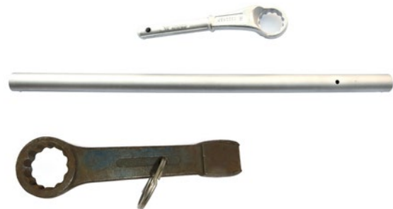
Abb. 29 oben: Zugringschlüssel mit Aufsteckrohr, unten: Schlag-Ringschlüssel
