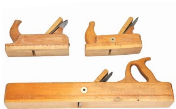
Abb. 56 Doppelhobel, Putzhobel und Raubank
