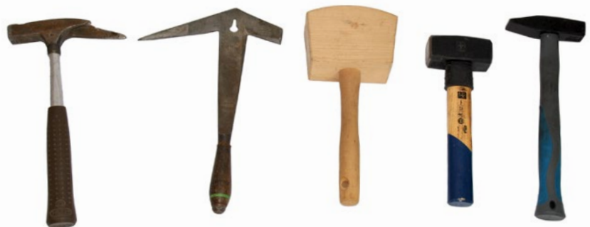
Abb. 13 Hammertypen Latthammer Schieferhammer Holzhammer Fäustel Schlosserhammer
