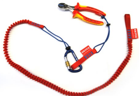
Abb. 5 Seitenschneider an einer Verliersicherung
