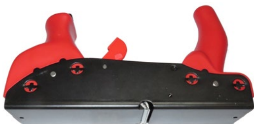
Abb. 57 Handhobel aus Metall und Kunststoff
