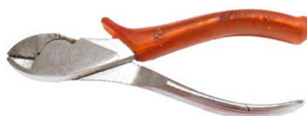
Abb. 39 Seitenschneider einsatzfähig: von weichem Draht bis Federstahl
