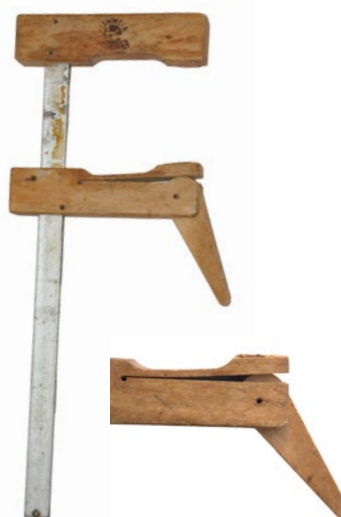
Abb. 61 Holzzwinde, rechts Zunge mit Excenterhebel
