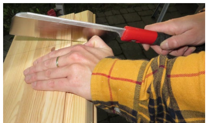
Abb. 47 Führen eines Sägeblatts beim Anschnitt
