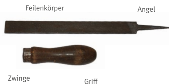
Abb. 48 Bezeichnungen an der Feile
