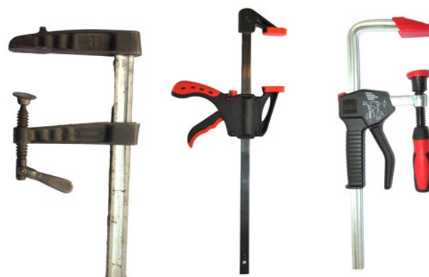
Abb. 60 links Schraubzwinde mit Knebel, Mitte Einhandzwinde, rechts Einhandzwinde mit Spindel
