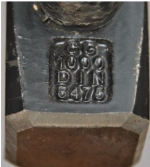
Abb. 1 Eingeprägte Norm an einem Fäustel 1
