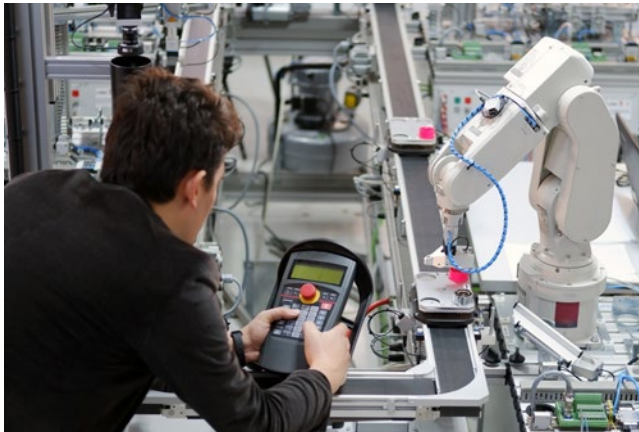
Abb. 14 Bedienung eines Industrieroboters mit Fernbedienung
