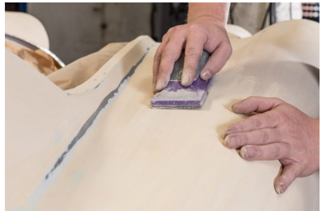
Abb. 15 Anschleifen von Werkstücken
