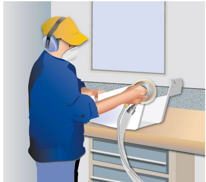
Abb. 18 Schleifen von legiertem Metall
