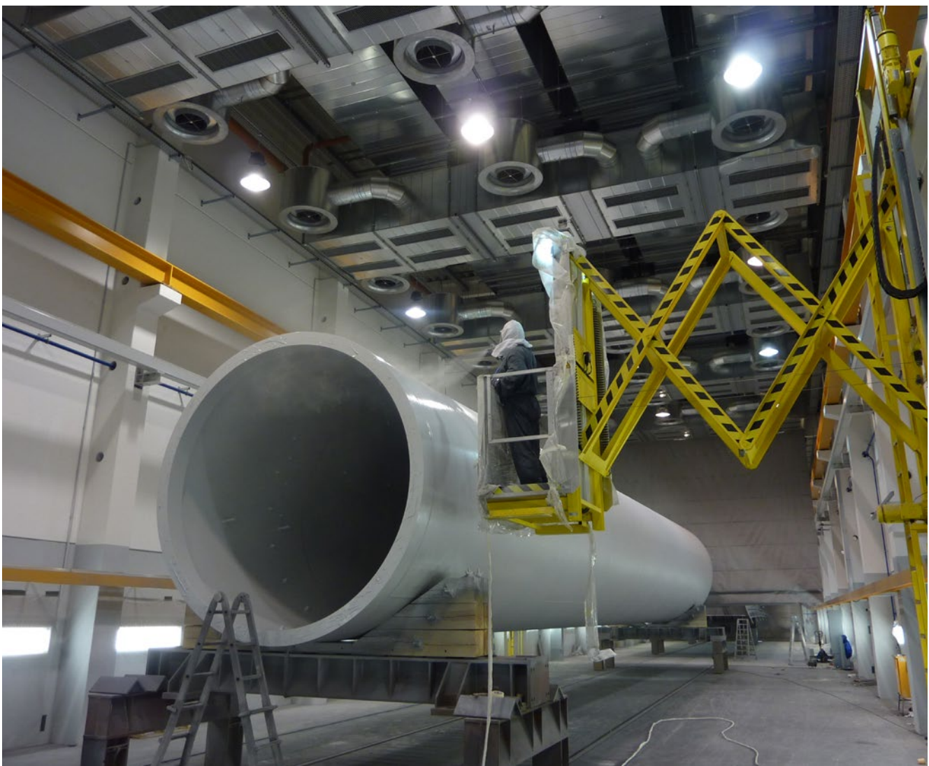
Abb. 31 Lackieren eines großen Werkstücks in einer Lackierkabine mit Absaugung
