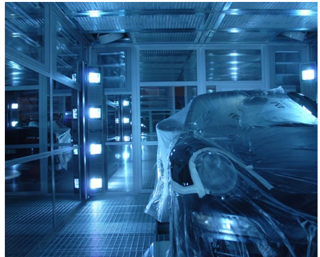
Abb. 26 Kombikabine in Spezialausführung mit UV-Strahlern
