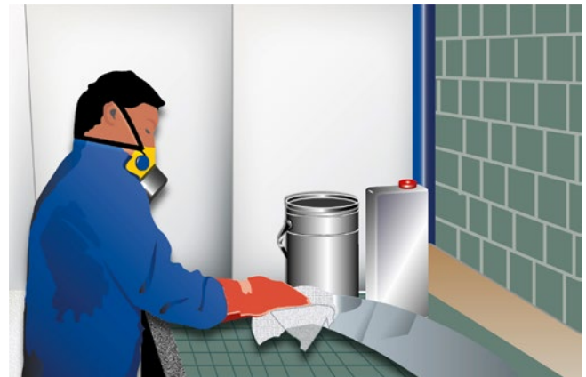
Abb. 14 Reinigung von Metall mit Tuch und Lösemittel
