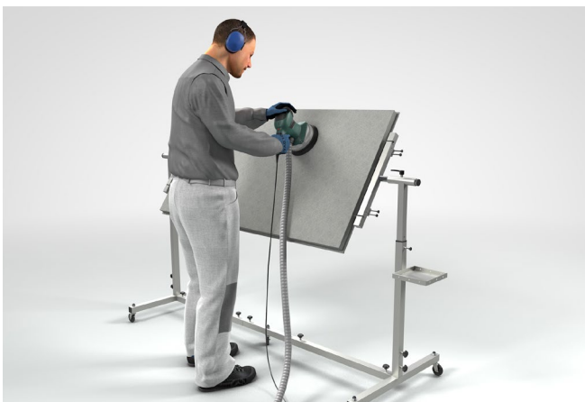
Abb. 19 Arbeiten in aufrechter Körperhaltung ohne einen Haltungswechsel durch drehbare Haltevorrichtung oder höhenverstellbaren Montagetisch
