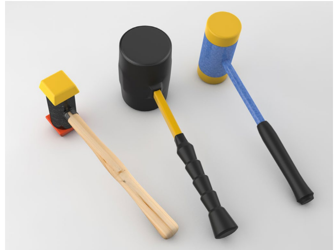
Abb. 29 Rückschlagfreie Hämmer reduzieren die Belastung des Hand-Arm-Systems
