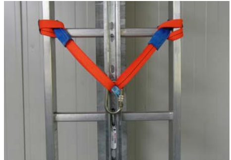
Abb. 23 Anschlagen an einer Steigleiter mit Seitenholmen durch beidseitiges Umschlingen der Leiterholme über einer Leitersprosse
