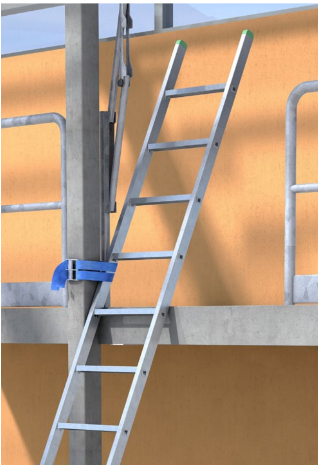
Abb. 1 gesicherte Leiter als Verkehrsweg mit 1 m Überstand
