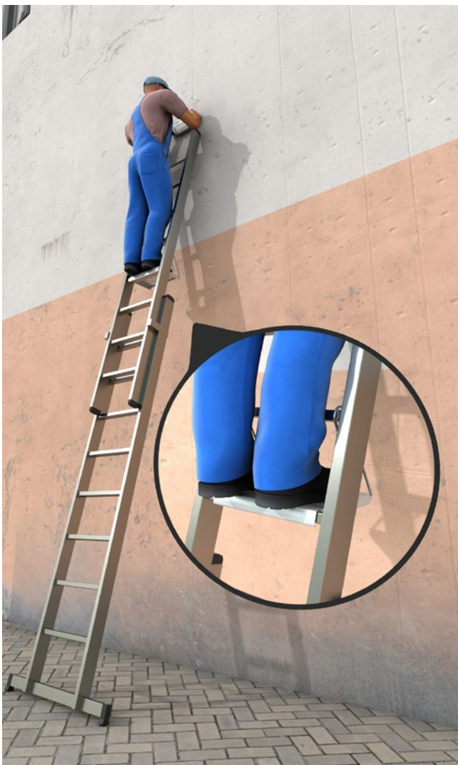
Abb. 17 Schiebeleiter mit Einhängepodest
