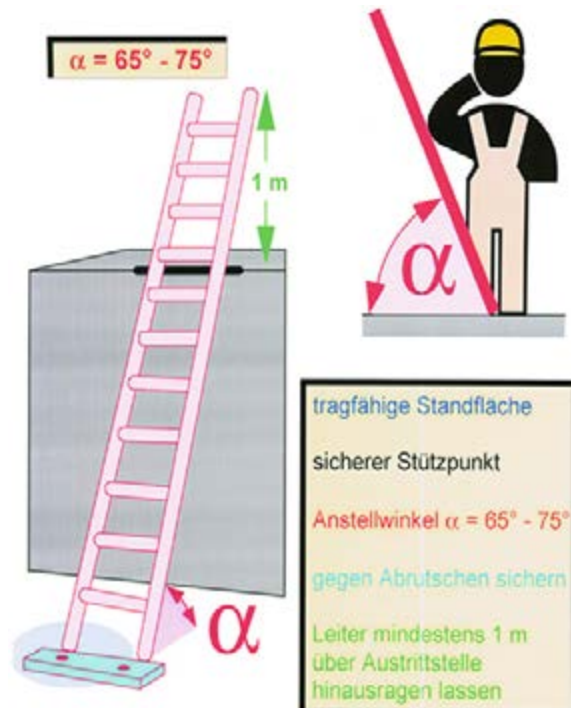
Abb. 4-2 Sichere Aufstellung einer Anlegeleiter
