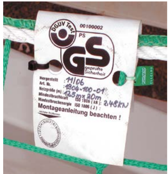
Abb. 4-13 Kennzeichnung mit Prüfnachweis
