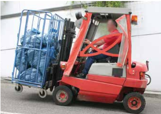
Bild 6-23: Last immer bergseitig führen
