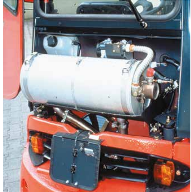
Bild 3-1: Gabelstapler mit Rußfilter und integrierter Regenerations-einrichtung
