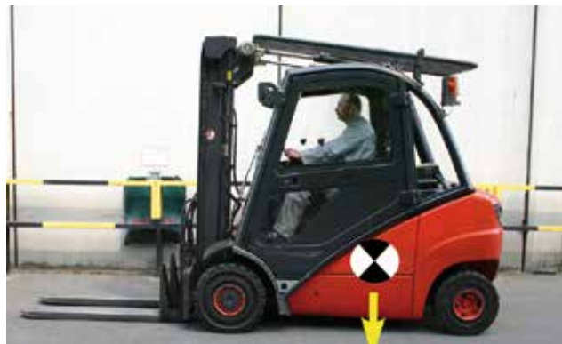
Bild 6-19: Der Schwerpunkt des Gabelstaplern und ...
