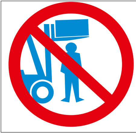
Bild 2-3: Anschlag „Aufenthalt unter der Last verboten“
