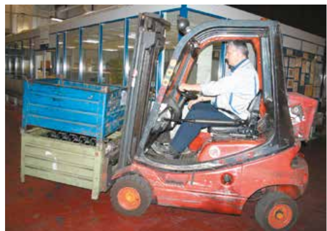
Bild 6-14: Nach hinten geneigter Hubmast
