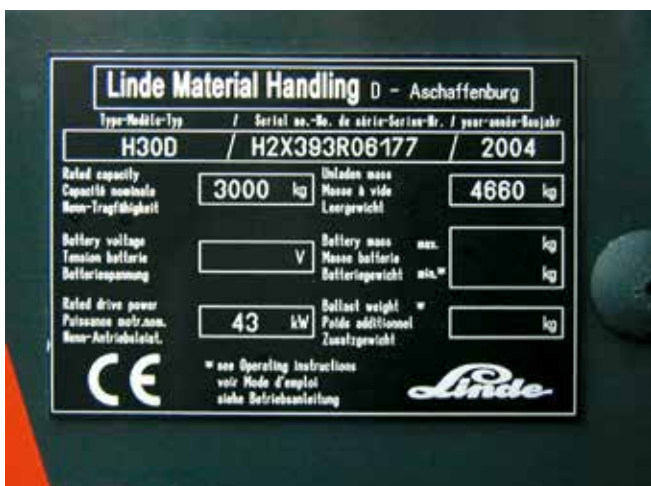
Bild 2-1: Fabrikschild mit CE-Zeichen für ein Flurförderzeug
