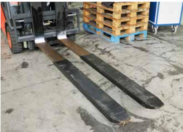
Bild 8-6: Gabelstapler mit Teleskopgabeln
