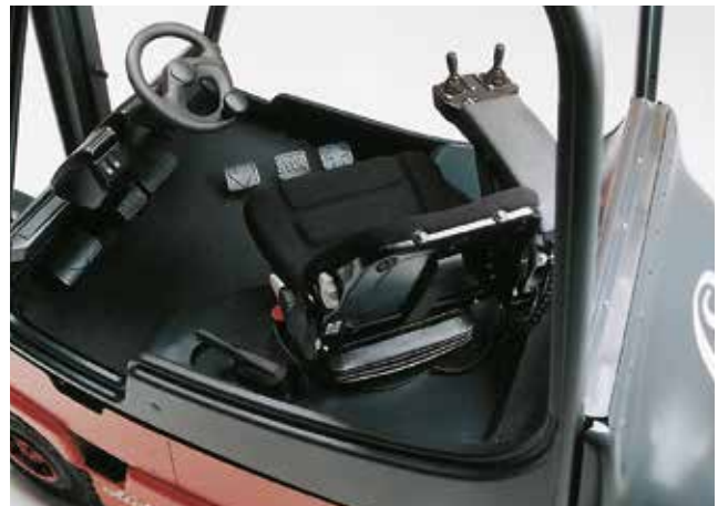
Bild 6-18: Drehbarer Fahrersitz – System „Linde“
