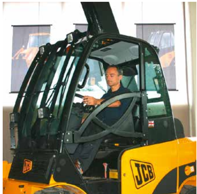
Bild 2-7: Bügeltüren als Rückhalteeinrichtung.
