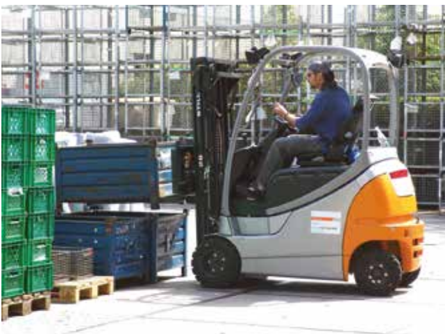
Bild 2-4: Gabelstapler mit Fahrerschutzdach
