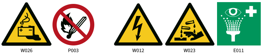
Abb. 11 Mögliche Kennzeichnungen für Batterieräume, Ladeplätze oder Laderäume
