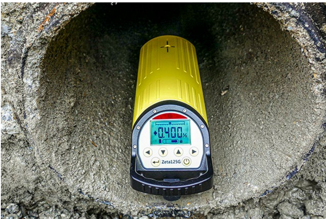
Abb. 9 Kanalbaulaser (Klasse 2M)
