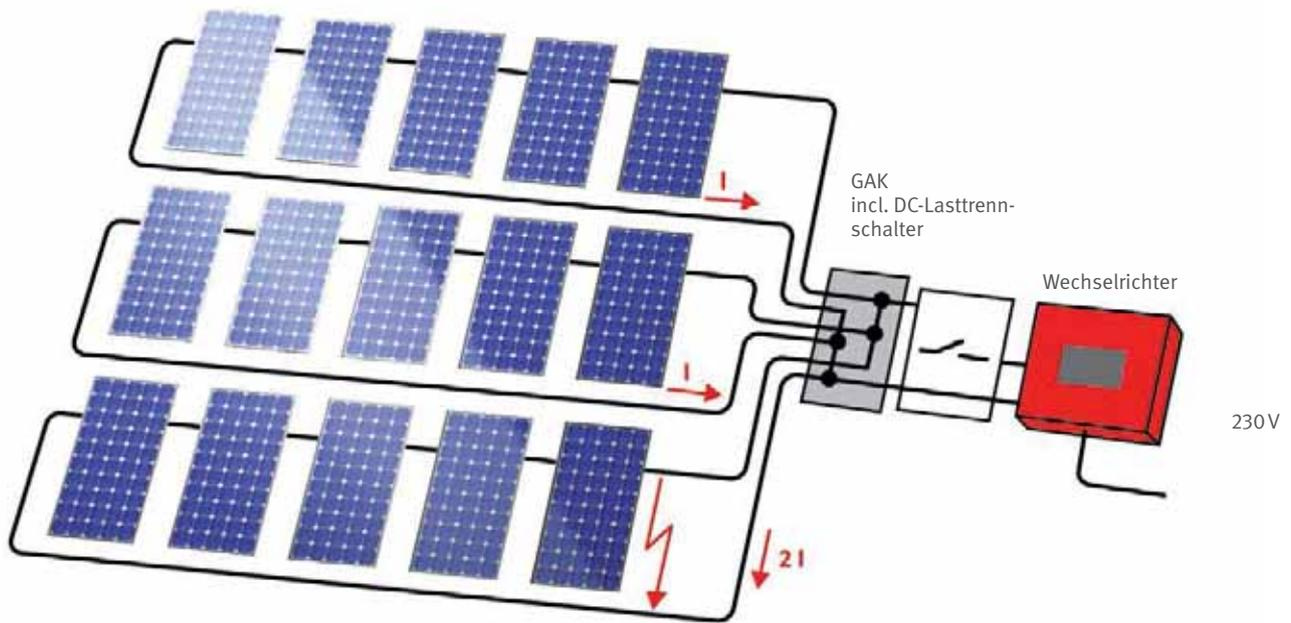
Abb. 12 Stromfluss in parallel geschalteten Strings bei Kurz- oder Erdschluss in einem String (Prinzipdarstellung)
