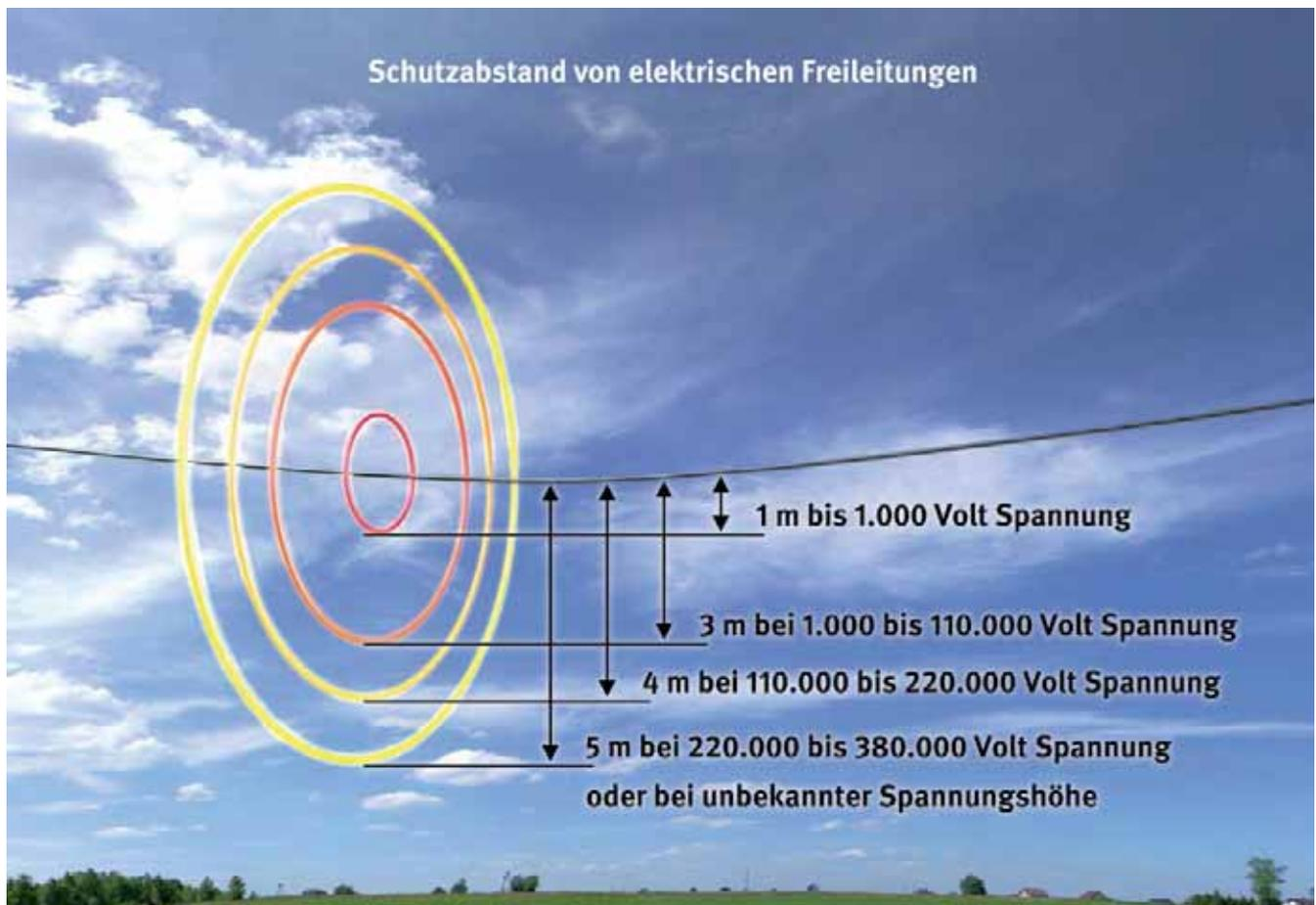
Abb. 23 Schutzabstände, hier z. B. bei einer Freileitung
