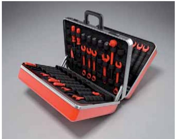
Abb. 19 Isolierendes Werkzeug
