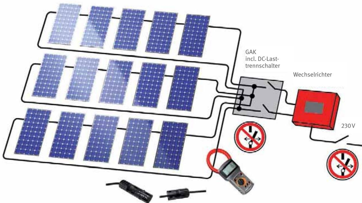
Abb. 15 Nach „Abschalten“ und „Gegen Wiedereinschalten sichern“ wird durch Verwendung einer Strommesszange die Stromfreiheit geprüft. Erst dann kann der einzelne String gefahrlos mittels der DC-Steckverbinder geöffnet werden (Prinzipdarstellung)..
