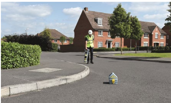
Abb. 8 Aktive Ortung, im Vordergrund Sender zur Signaleinkopplung
