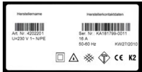
Abb. 2: Geeigneter Leitungsroller und Typschild mit notwendigen Angaben
