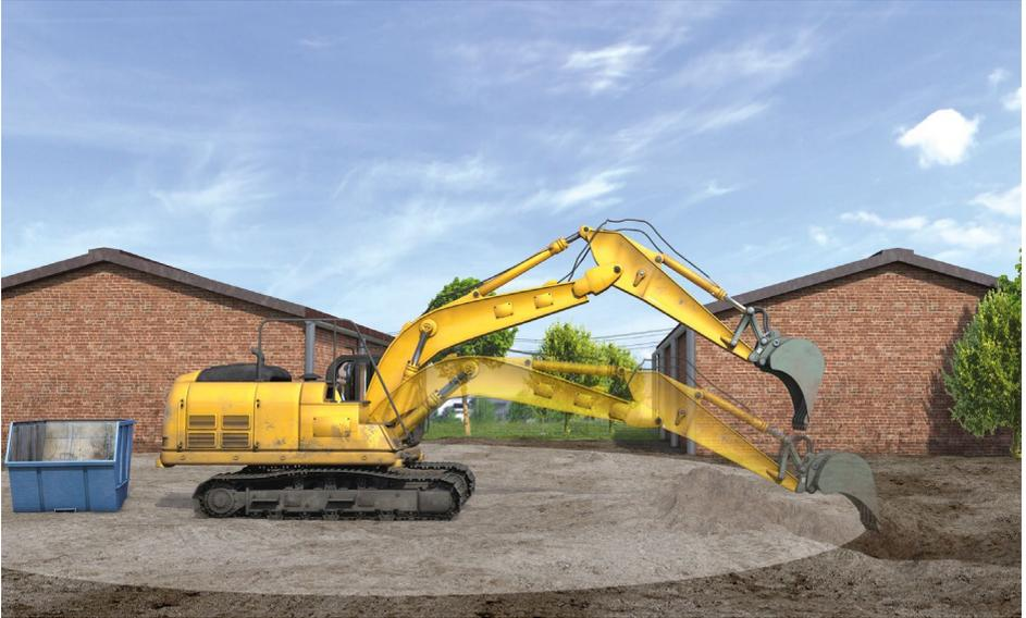
Abb. 18 Gefahrbereich beim Betrieb eines Baggers
