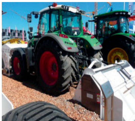
Abb. 2 Traktor mit Ballastierung und getragenen Anbaugerät
