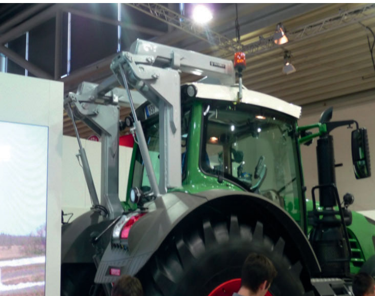
Abb. 3 Vom Hersteller angebotener zusätzlicher Überrollschutz (ROPS)
