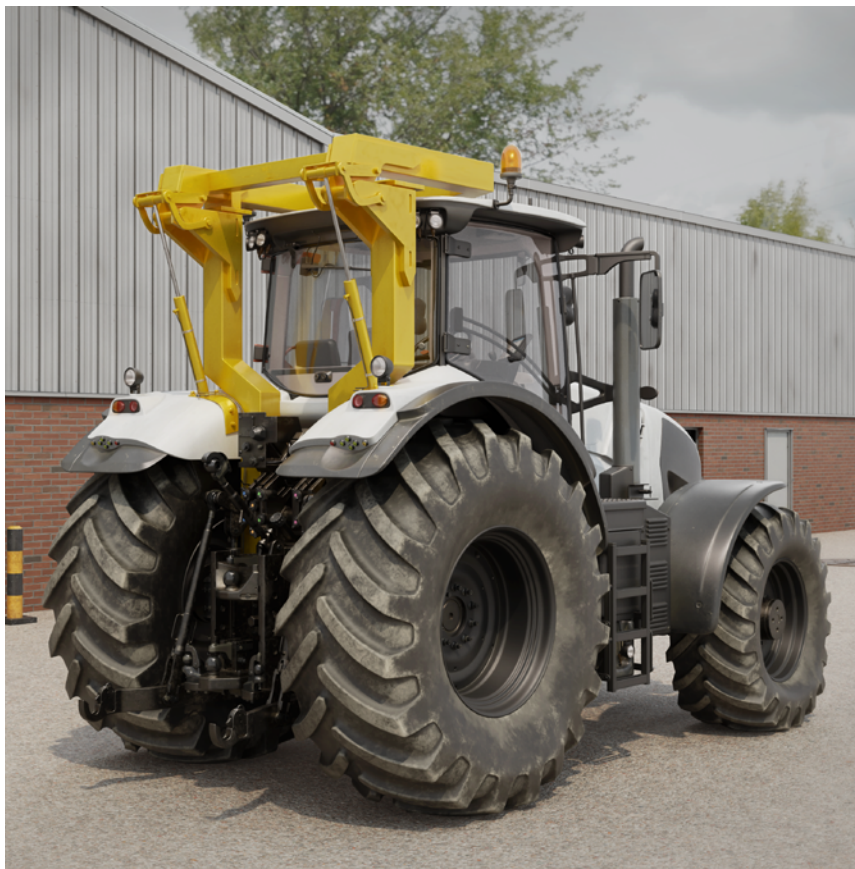
Abb. 3 Vom Hersteller angebotener zusätzlicher Überrollschutz (ROPS)
