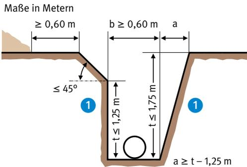
Abb. 8 Graben mit geböschten Kanten
