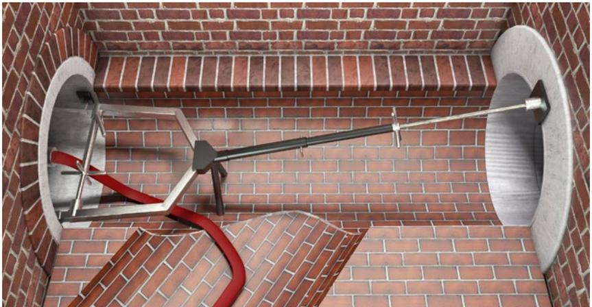
Abb. 17 Absperrerelement mit Ausschubsicherung
