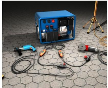
Abb. 3 Betrieb sämtlicher Betriebsmittel über jeweils eine PRCD
