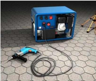
Abb. 2 Einzelnes Betriebsmittel, direkt am Stromerzeuger angeschlossen
