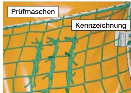
Bild 5-30: Kennzeichnung mit Prüfnachweis
