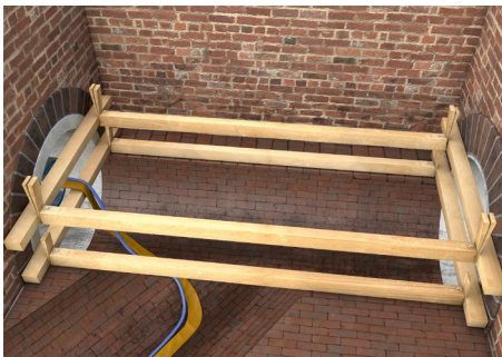
Abb. 2 Formgeschlüssige Ausschubsicherung mittels zimmermannsmäßigem Verbau
